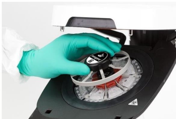
Figure 9. Placer l'anneau de retenue
