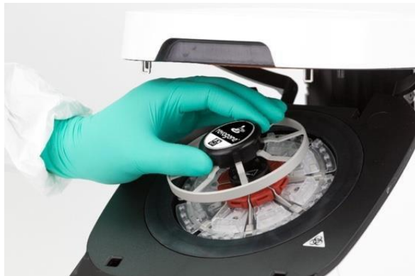
Abbildung 9. Platzierung des Retentionsrings
