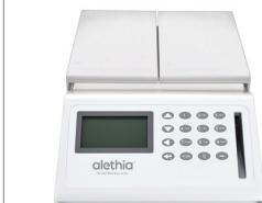
**7.** Fermer le dispositif et bien engager le loquet de verrouillage. Tapoter le dispositif sur la paillasse pour éliminer les bulles d'air. Examiner avec attention les tubes de réaction afin de s'assurer qu'il ne reste aucune bulle d'air dans le tube.
