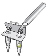
5. À l'aide d'une micropipette, transférer 50 µL d'échantillon traité thermiquement dans le puits TEST (gauche), puis transférer 50 µL d'échantillon traité thermiquement dans le puits CONTRÔLE (droite) du dispositif de test Alethia™.
