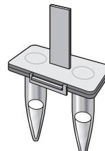
6. Fermer le dispositif et rabattre le loquet. Tapoter doucement le dispositif pour éliminer les bulles d'air piégées au fond des tubes. Examiner soigneusement les tubes de réaction pour s'assurer qu'il ne reste pas de bulles d'air.
