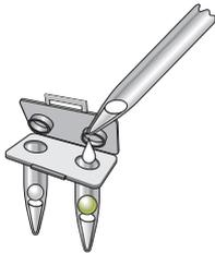
5. À l'aide d'une micropipette, transférer 50 µL d'échantillon traité thermiquement dans le puits TEST (gauche), puis transférer 50 µL d'échantillon traité thermiquement dans le puits CONTRÔLE (droite) du dispositif de test Alethia™.
