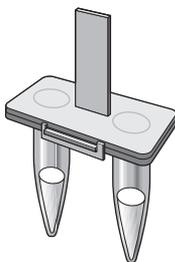
6. Fermer le dispositif et rabattre correctement le loquet. Tapoter le dispositif sur la paillasse pour éliminer les bulles d'air. Vérifier l'absence de bulles d'air dans les puits du dispositif.
