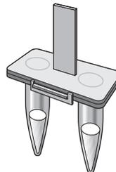
7. Fermer le dispositif et rabattre correctement le loquet. Tapoter le dispositif sur la paillasse pour éliminer les bulles d'air. Vérifier l'absence de bulles d'air dans les puits du dispositif.
