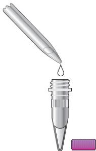
2. Transférer 25 µL du milieu dans un tube de Contrôle de dosage.
