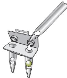
4. À l'aide d'une micropipette, transférer 50 µL d'échantillon traité thermiquement dans le puits TEST (gauche), puis transférer 50 µL d'échantillon traité thermiquement dans le puits CONTRÔLE (droite) du dispositif de test Alethia™.
