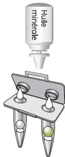
5. Ajouter 1 goutte d'huile minérale dans le puits TEST et le puits CONTRÔLE.
