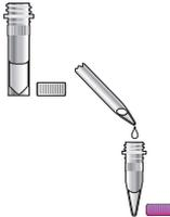
4. Transférer 50 µL du mélange dans le tube de contrôle de dosage. Mélanger au vortex pendant 10 secondes.
