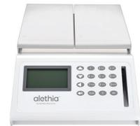
9. Insérer le dispositif de test Alethia™ dans l'Instrument Alethia™ et initier la réaction d'amplification et la détection.
